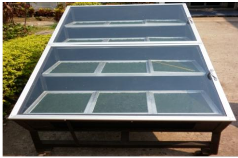
การทำแห้งด้วยตู้อบพลังงานแสงอาทิตย์
